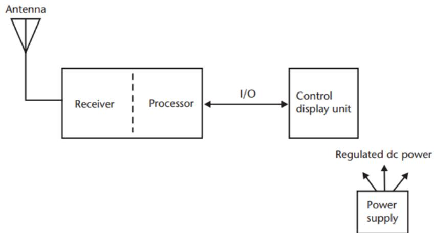
**Slika 17. Pojednostavljeni prikaz korisničke komponente GPS-a**
