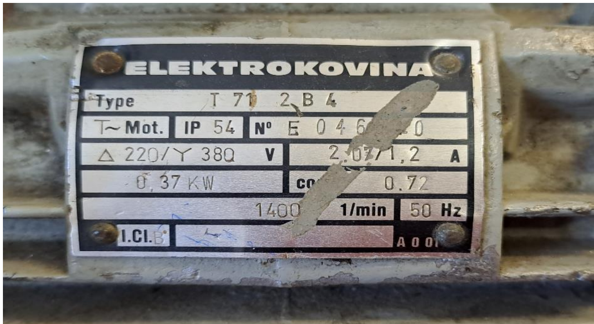
Slika 24: Natpisna pločica motora
