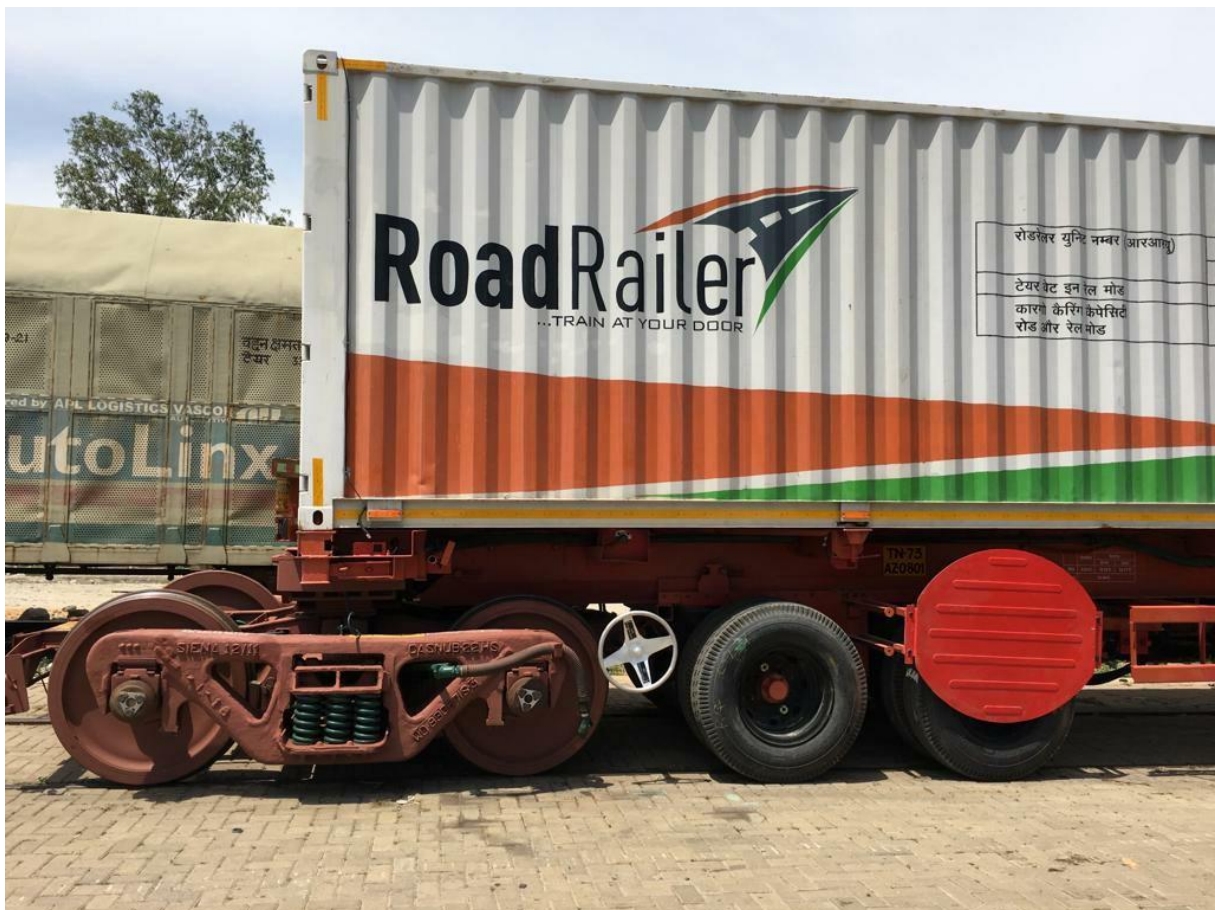
Fotografija 3. Dvoosovinsko željezničko podvozje Bimodalne tehnologije
