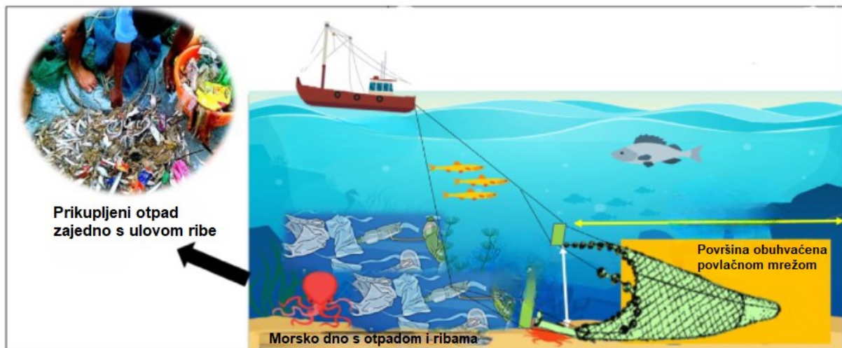
Slika 24. Ilustrirani princip rada povlačne mreže
