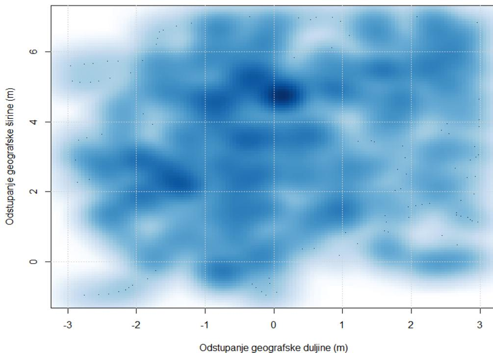
**Slika 44. Približni prikaz gustoće dvodimenzionalnog odstupanja, Samsung S8, 18/04/2023**
