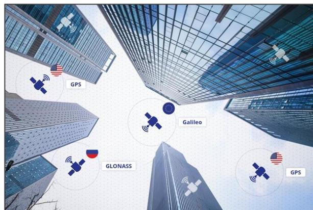
**Slika 8. Primjer blokiranja signala satelita umjetnim tvorevinama**
