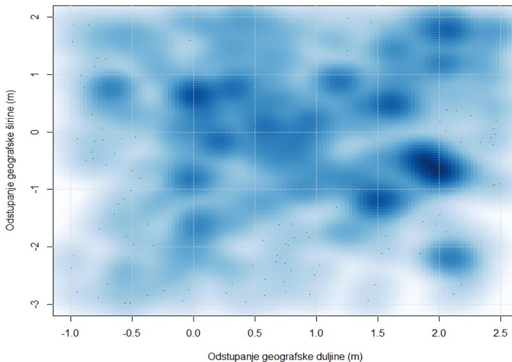
**Slika 30. Približeni prikaz gustoće dvodimenzionalnog odstupanja, Samsung A6, 18/04/2023**
