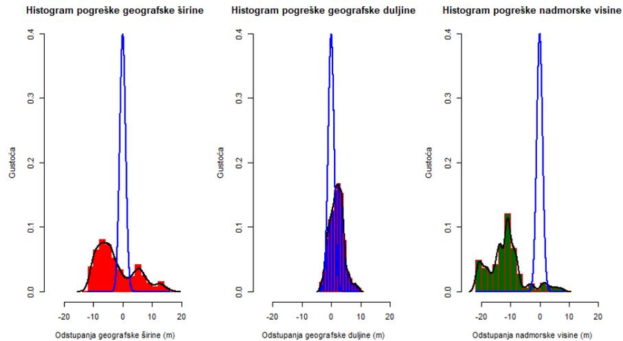
**Slika 34. Gustoće razdiobi pogrešaka odstupanja, Samsung S6, 18/04/2023**
