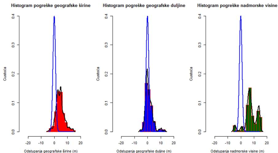
**Slika 41. Gustoće razdiobi pogrešaka odstupanja, Samsung S8, 18/04/2023**
