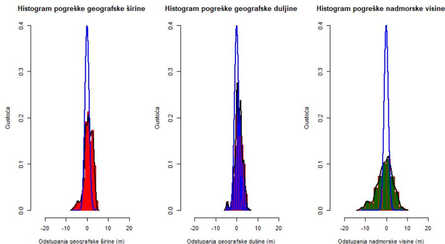
**Slika 27. Gustoće razdiobi pogrešaka odstupanja, Samsung A6, 18/04/2023**
