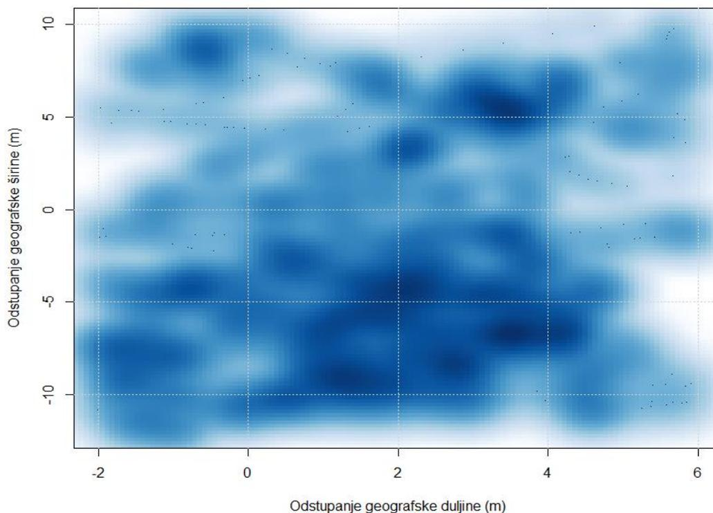
**Slika 37. Približeni prikaz gustoće dvodimenzionalnog odstupanja, Samsung S6, 18/04/2023**
