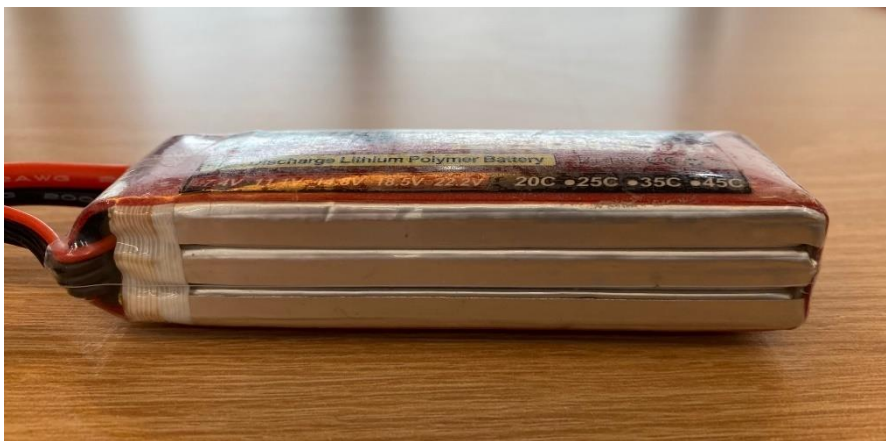
Slika 24. Prikaz oštećene baterije [23]
