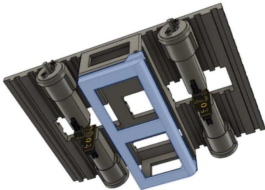
Slika 11. Prikaz poklopca baterije robota [16]
