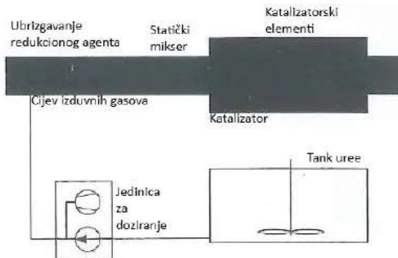
Slika 5. SCR sustav
