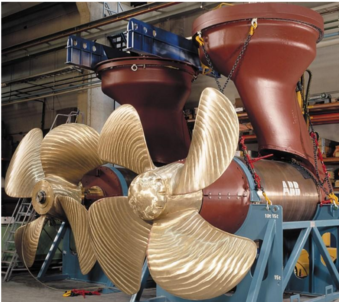
Slika 11. Azimutalni Porivnik broda Oasis klase prije montaže na trup broda
