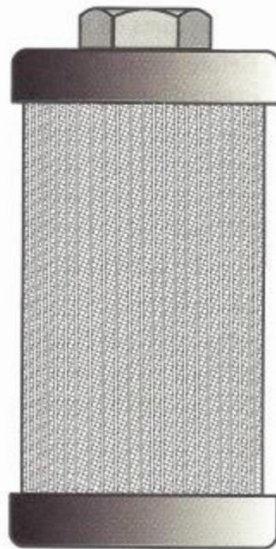
Slika 11 filter na usisnoj strani sa 100 slojeva
