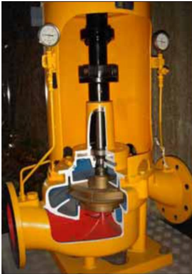
Slika 13: Presjek cirkulacijske pumpe glikola/vode [2]
