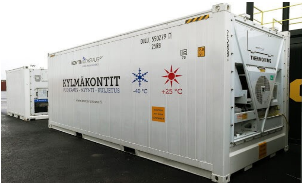
Slika 13. Prikaz izolacijskog kontejnera
