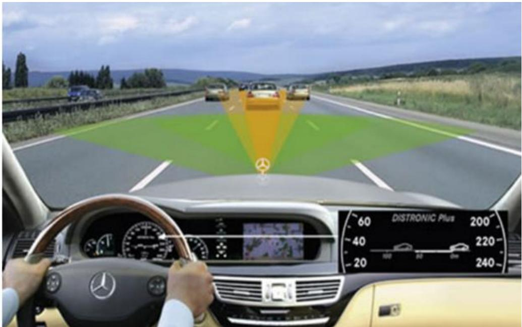
Slika 11. Primjer korištenja radara dugog i kratkog dometa
