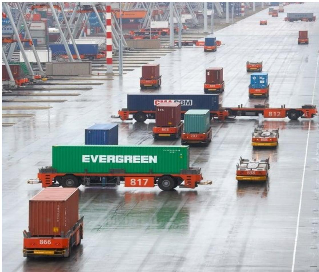
Slika 21. Primjer korištenja AGV-a na kontejnerskom terminalu
