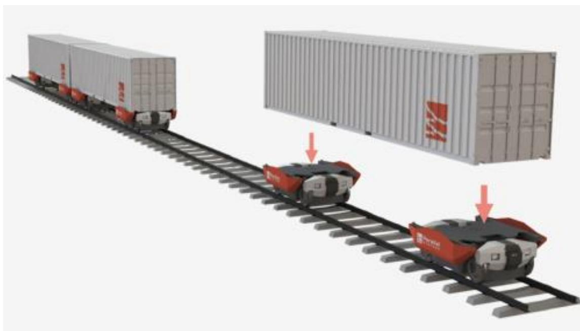
Slika 23. Prikaz Parallel System autonomnog željezničkog vozila
