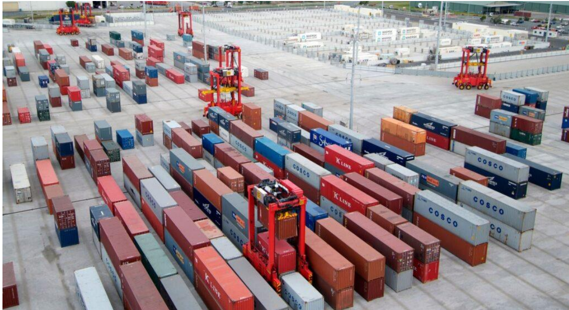
Slika 20. AutoStrad automatizirani kontejnerski prijenosnici
