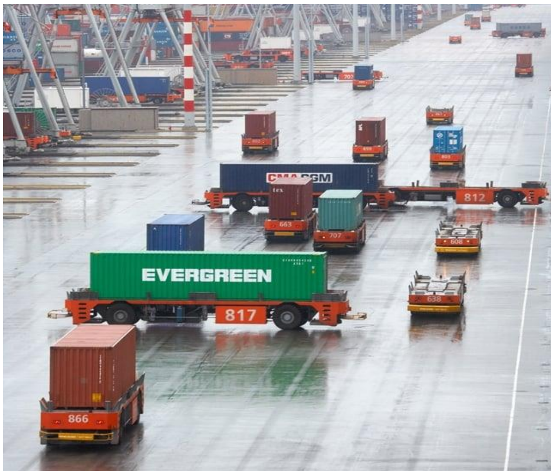
Slika 21. Primjer korištenja AGV-a na kontejnerskom terminalu
