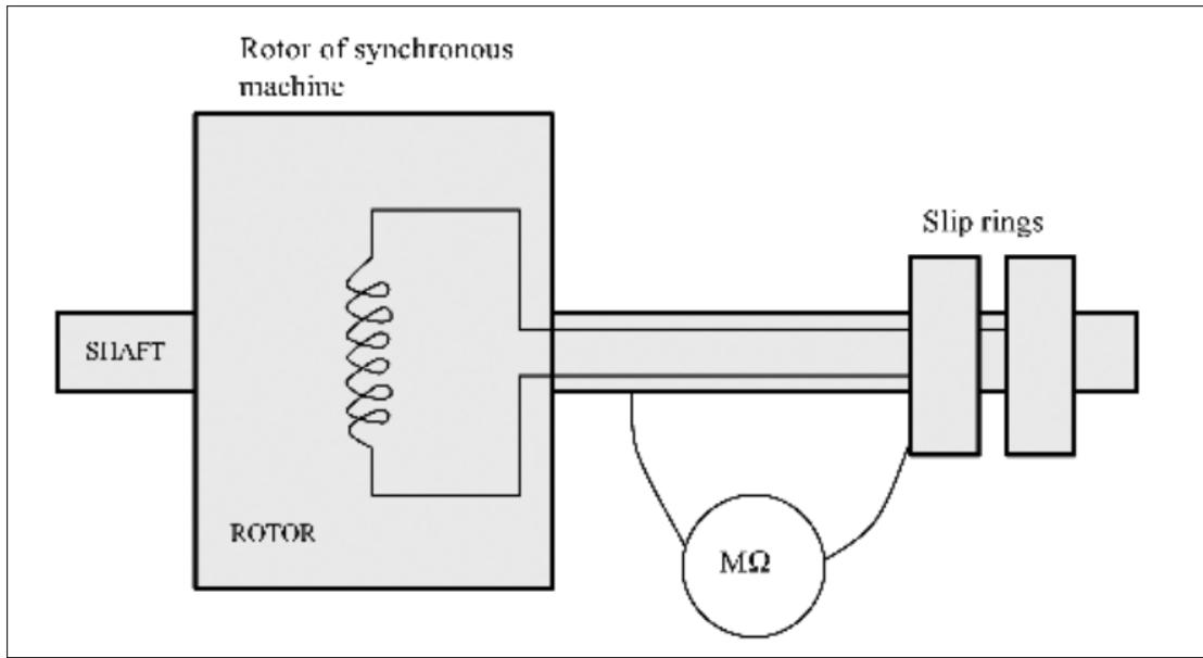
**Slika 26.** Mjerenje otpora izolacije na rotoru i statoru uzbudnika
