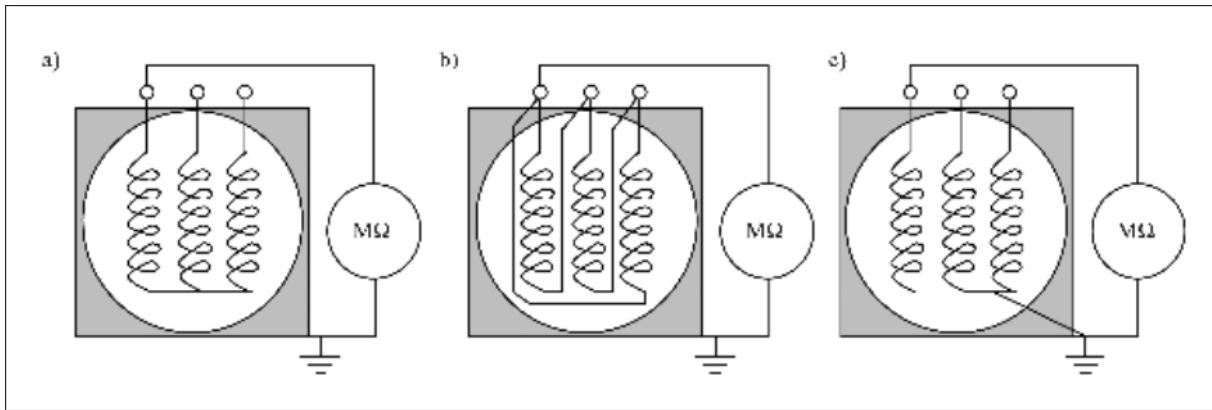
**Slika 25.** Varijante mjerena otpora izolacije statorskih namotaja
