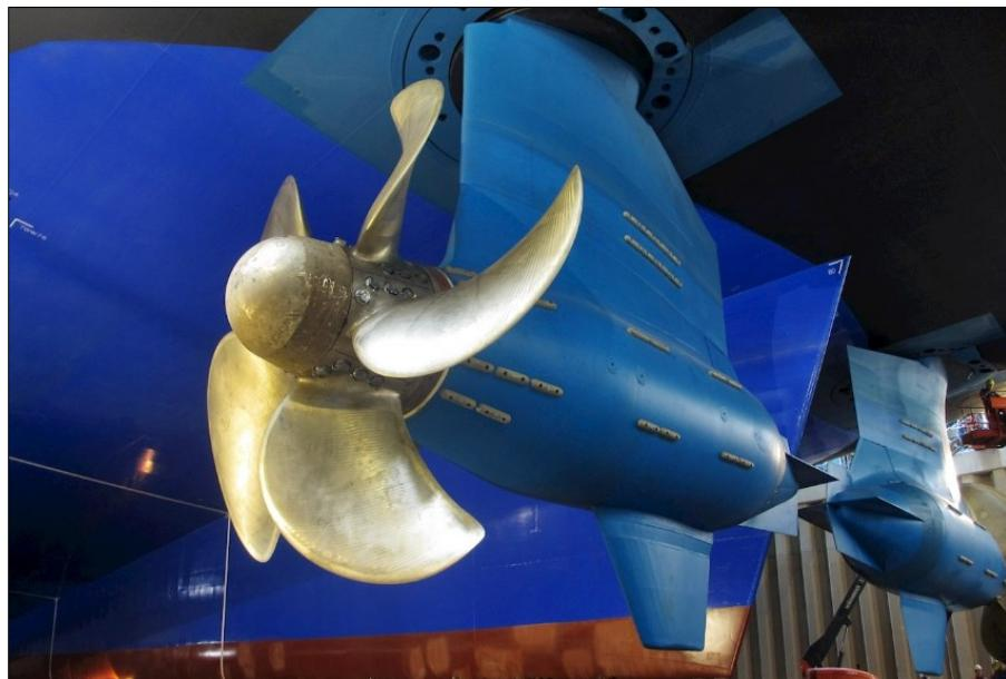
**Slika 19.** Vanjski izgled jedinice Azipod-a
