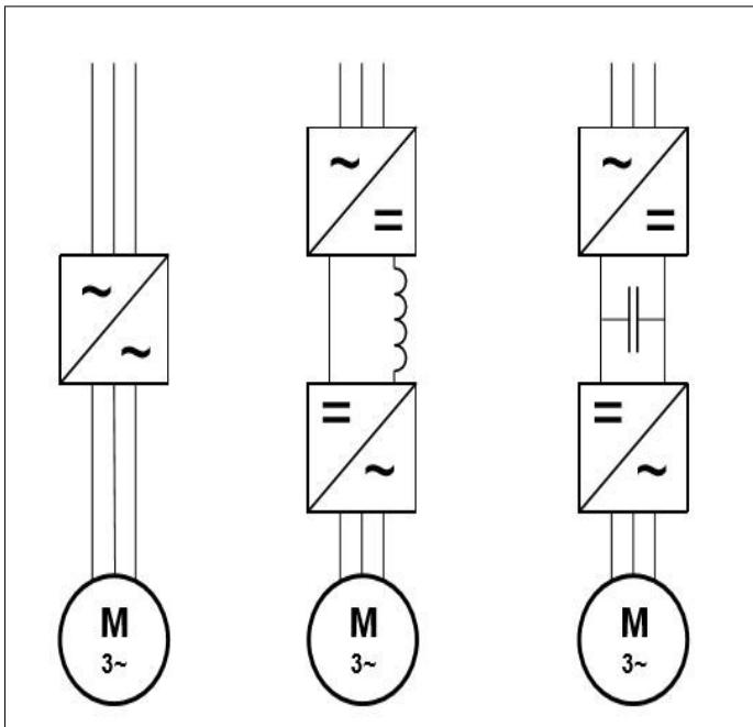
**Slika 12.** Pojednostavljeni prikaz direktnih i indirektnih pretvarača frekvencije
