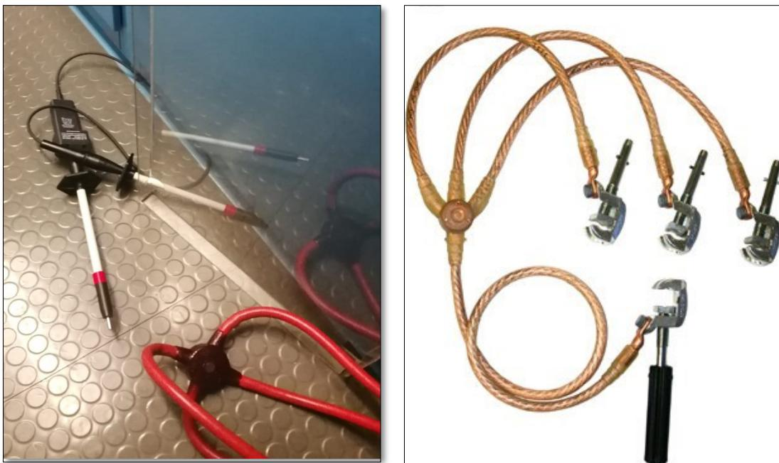
**Slika 28.** Visokonaponski ispitivač (lijevo) i alat za uzemljenje „pauk“ (desno)
