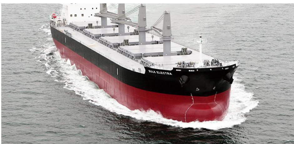
Slika 3-. konvencionalni brod za rasuti teret Electra, 66 000 DWT
