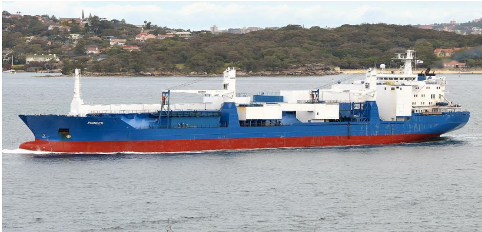
Slika 6: BIBO brod MV Pioneer 20 000 DWT
