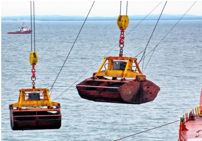
Slika 20: Grabilice za ukrcaj/iskrcaj rasutog tereta
