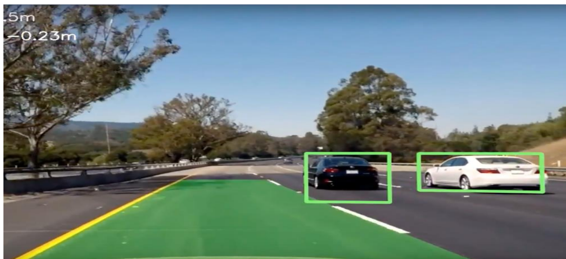
Slika 10. Prikaz detekcije prometne trake i vozila
