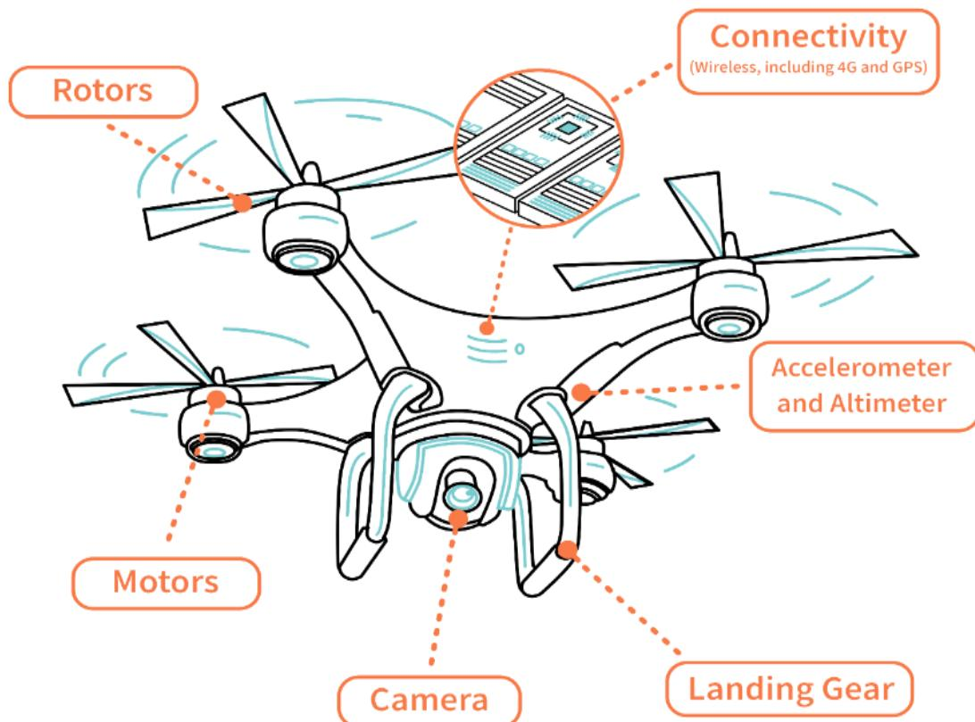
Slika 2. Dijelovi drona
