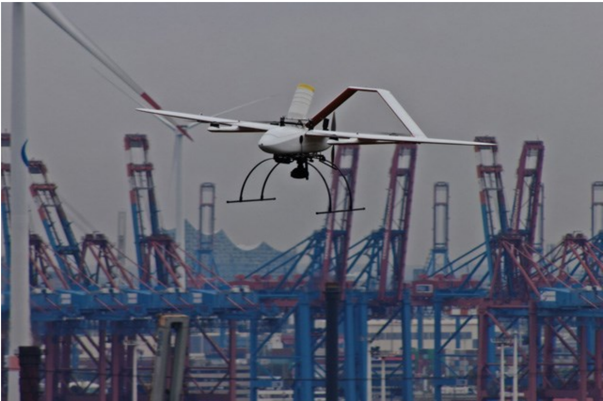
Slika 5. Bepilotna letjelica kao mobilni senzorski sustav u luci Hamburg
