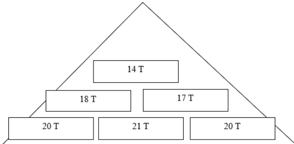
**Shema 1.** Piridalni sistem slaganja kontejnera prema težinama
