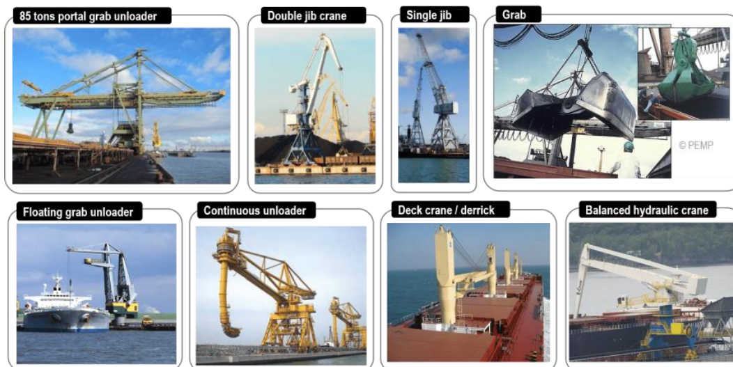
Slika 8: Primjer brodskih i obalnih prekrcajnih sredstava
