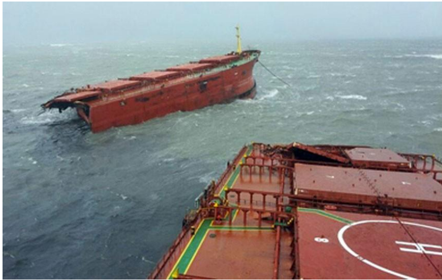
Slika 24: Pucanje brodske konstrukcije zbog zamora metala
