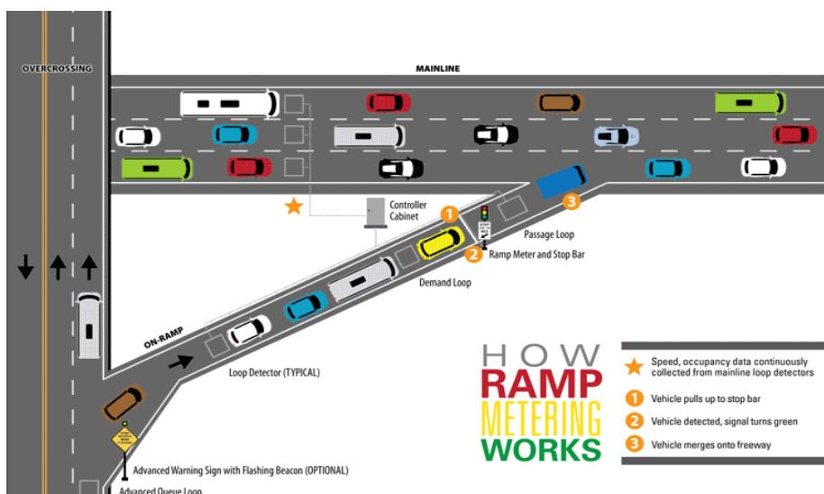
Slika 5. Signalna rampa na ulazu na autocestu
