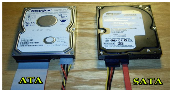
Slika 7. Usporedba veličine ata i sata konektora
