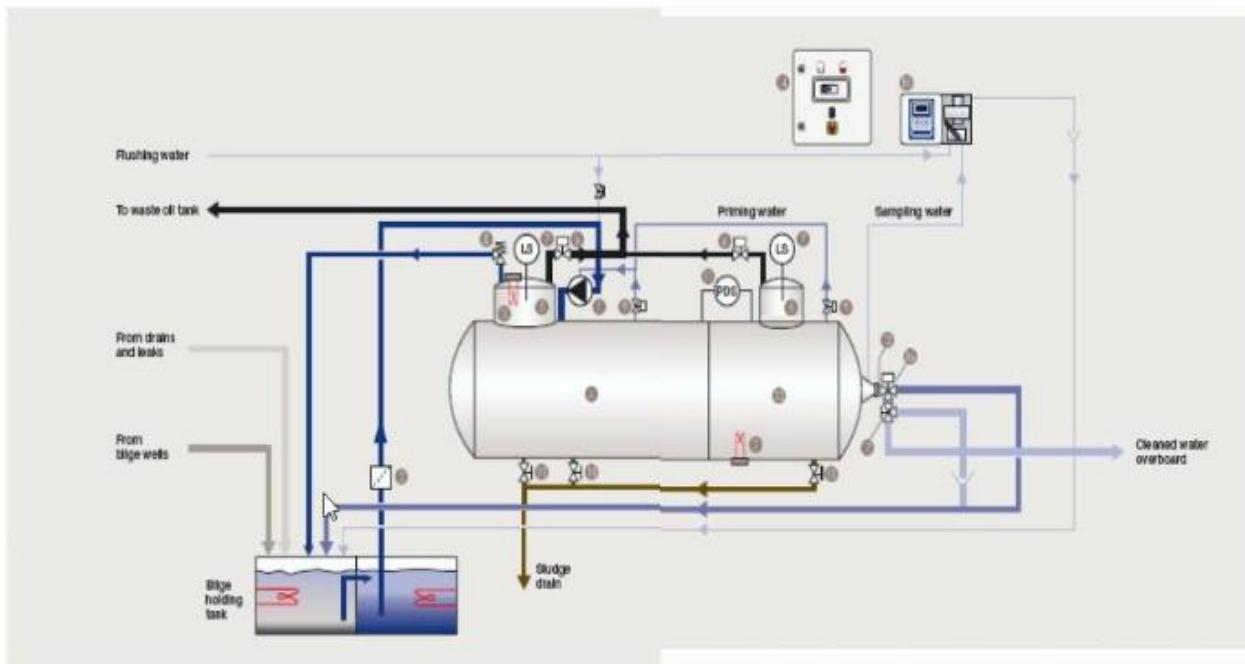
Slika 19. Prikaz sustava za odvajanje ulja iz zauljenih voda
