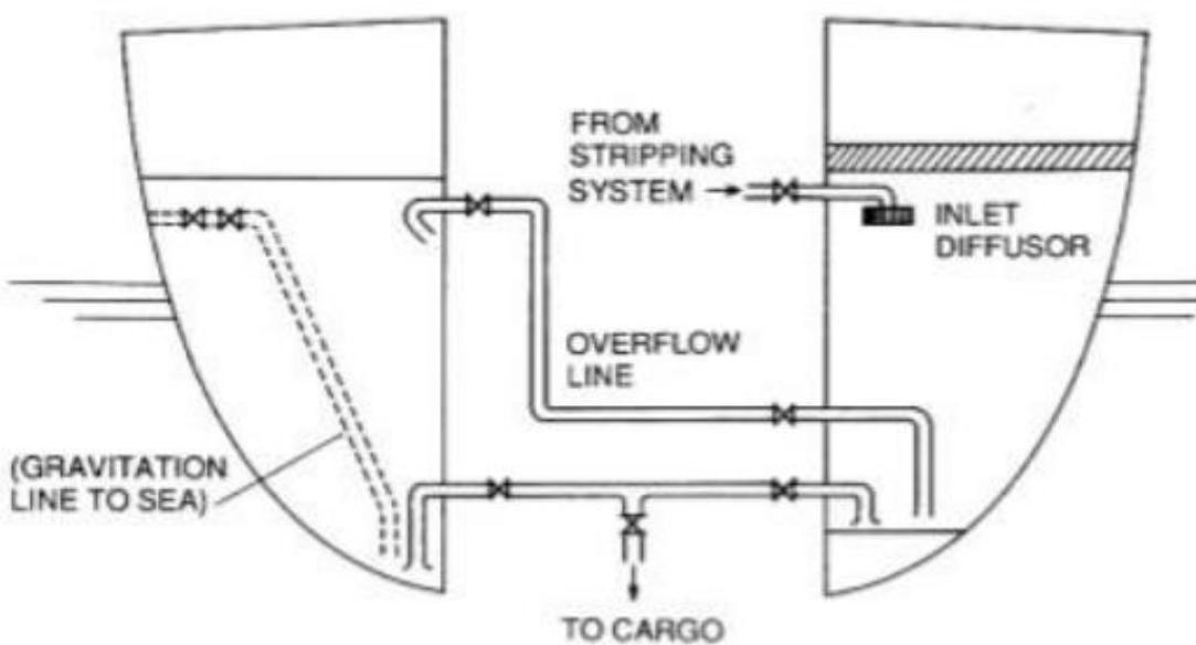
Slika 20. Prikaz pravilnog rasporeda slop tanka
