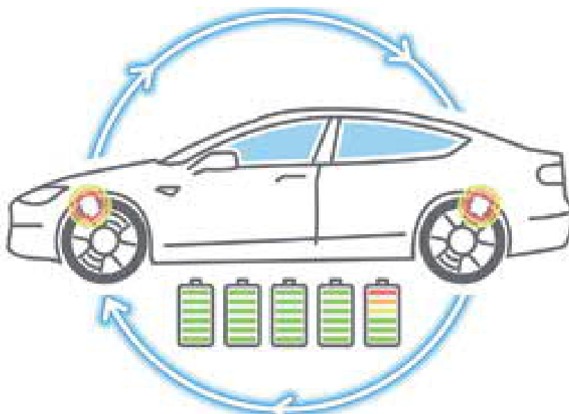
Slika 23. Prikaz principa rada regenerativnog kočenja
