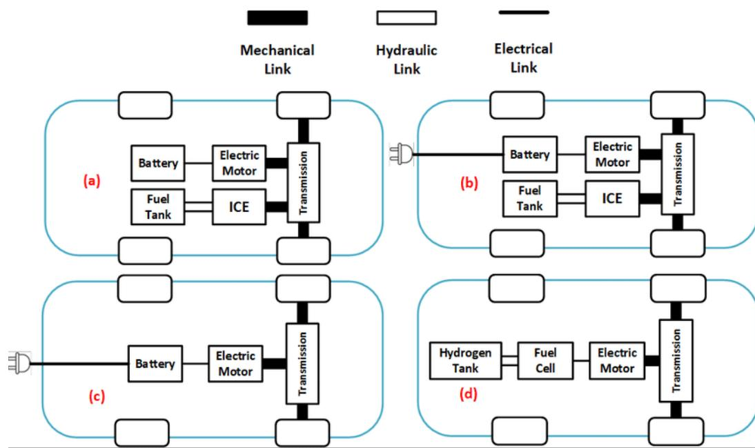
Slika 1 Osnovna struktura različitih vrsta električnih vozila (EV). a) HEV; b) PHEV; c) BEV; i d) FCEV
