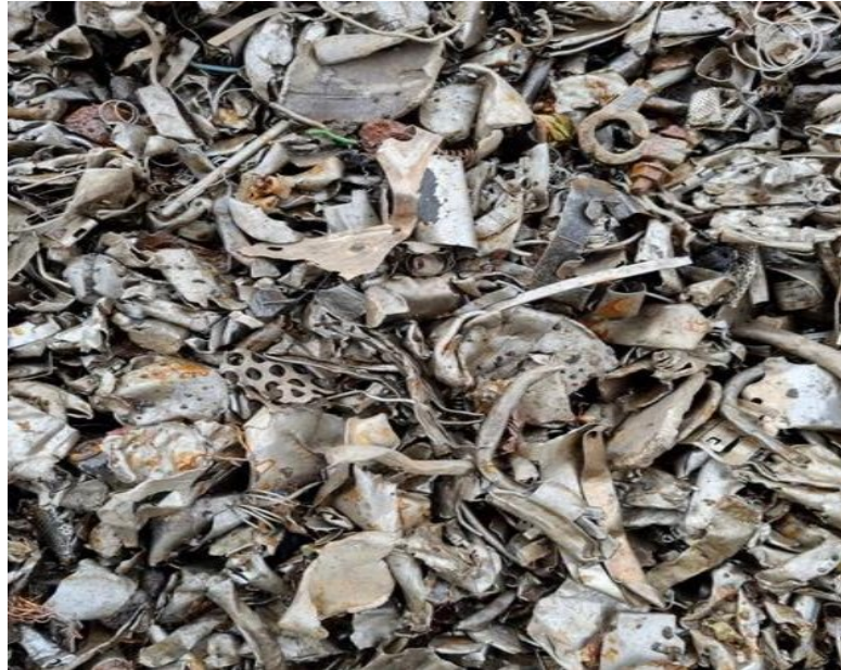
Slika 6. Primjer otpadnog željeza kvalitete E40 – Shredded steel
