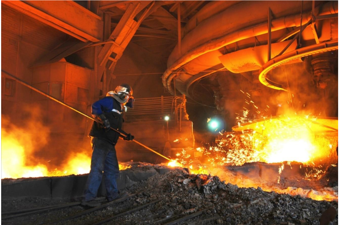
Slika 24. Taljenje otpadnog željeza
