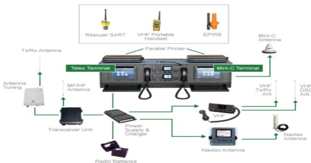
Slika 2. Radio komunikacijski uređaji na brodovima koji su opremljeni u skladu s GMDSS propisima
