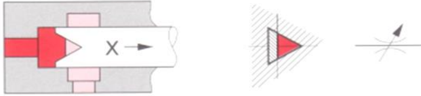
Slika 14. Regulator protoka sa simbolom
