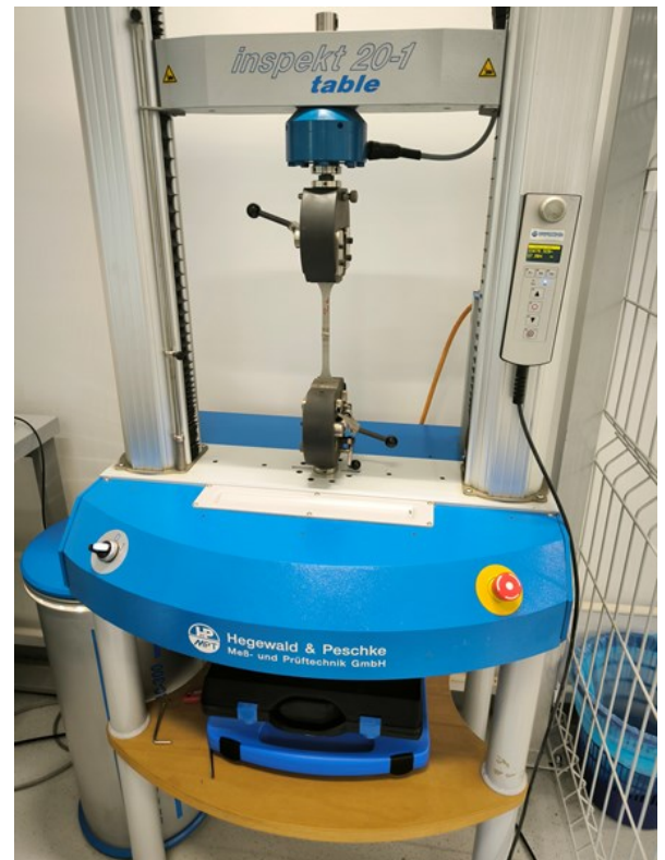
Slika 24. Univerzalna kidalica Hegewald & Peschke Inspekt 20 kN Izvor: Autor
