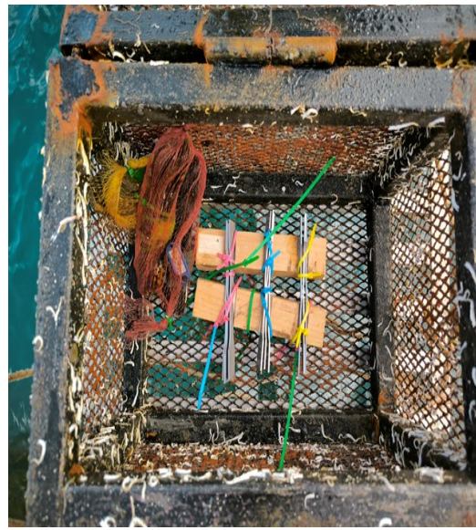
Slika 22. Priprema uzoraka i izlaganje uzoraka morskoj okolini Izvor: Autor
