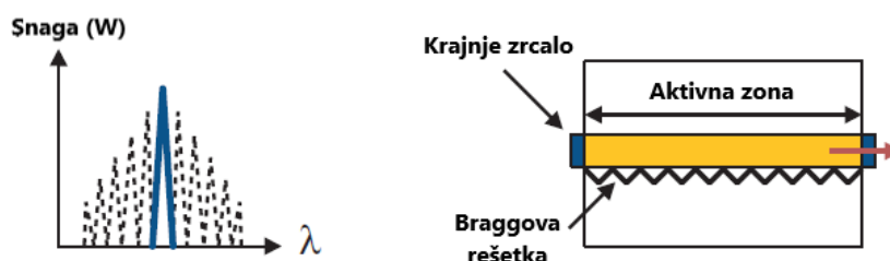
Slika 19. Emitirani spektar DFB lasera i shematski dijagram DFB lasera
