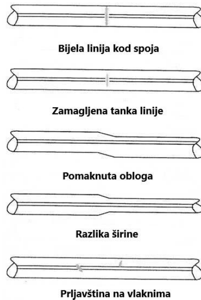
Slika 11. Mane kod spajanja optičkih vlakana
