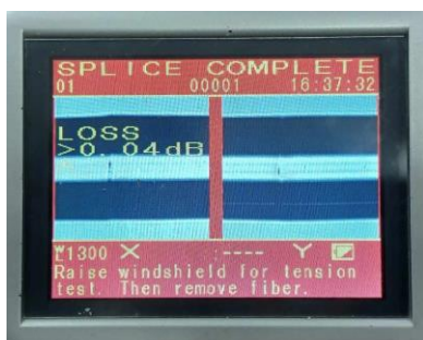
Slika 13. Prevelik iznos prigušenja
