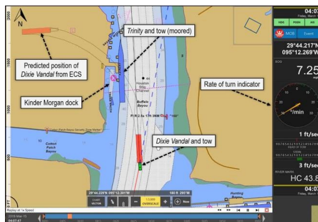
Slika 4: Zaslon ECS-a na brodu Dixie Vandal prije nesreće. (National Transportation Safety Board [NTSB], 2012).
