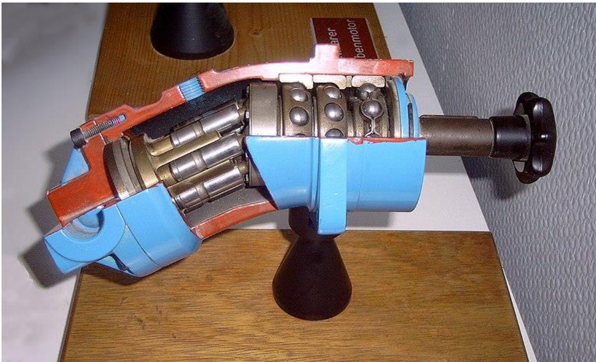
Slika 5. aksijalna klipna pumpa sa nagibnim rotorom
