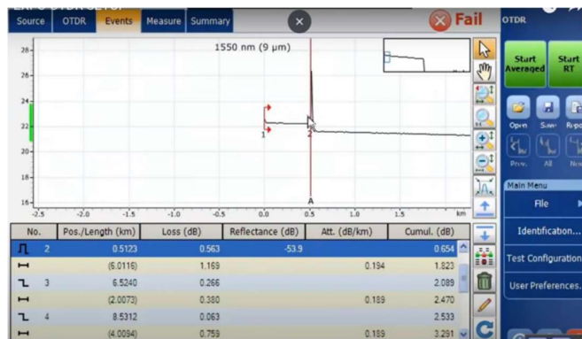
Slika 28. Prikaz spoja testnog vlakna i ostatka sustava
