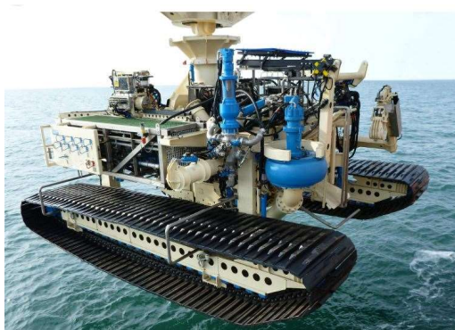
Slika 15. Trencher – kopač koji se koristi za iskope kanala prije samog polaganja kabela na morsko dno
