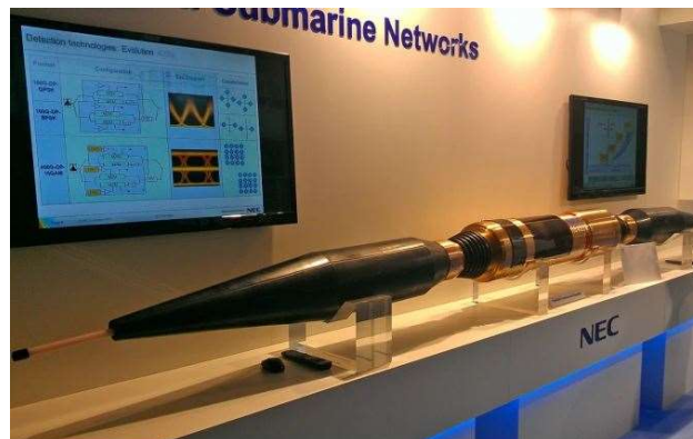
Slika 23. Tipično pojačalo podmorskog kabela
