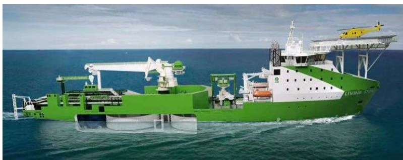
Slika 9. Presjek broda prikazuje pozicije dvaju vrtuljka u utrobi broda. Pogodnije od spremanja kabela na palubi radi vremenskih uvjeta.
