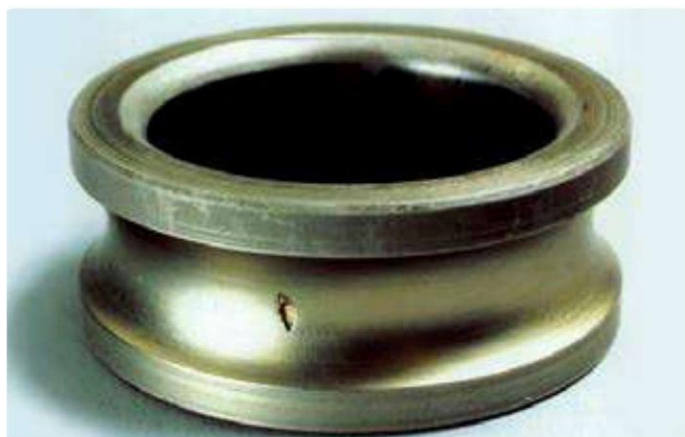
Slika 3. Pukotina u ležaju zbog zamora materijala [1]
