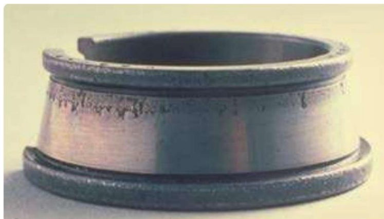
Slika 1. Oštećenje valjnog ležaja [1]
