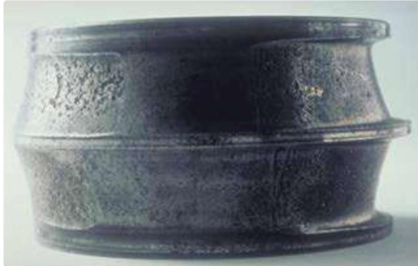
Slika 5. Istrošeni valjni ležaj(abrazija) [1]
