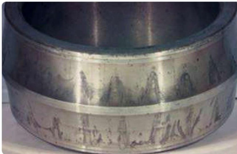
Slika 9. Korozija na ležaju uzrokovana vodom u mazivu [1]
