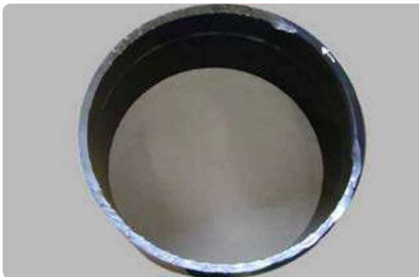
Slika 7. Oštećenje vanjskog prstena ležaja [1]
