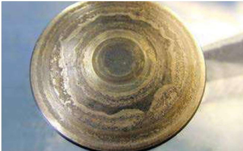
Slika 8. Mrljanje na potisnoj strani valjnog ležaja (adhezija) [1]
