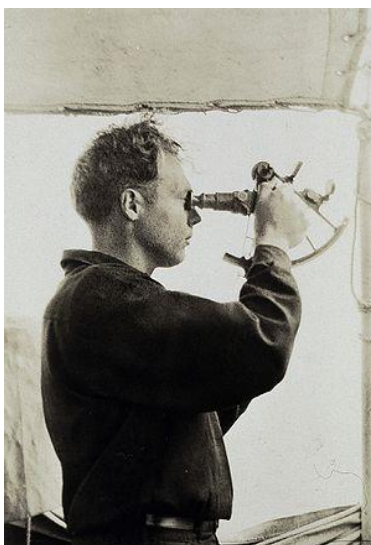
Slika 17. Prikaz korištenja sekstanta
