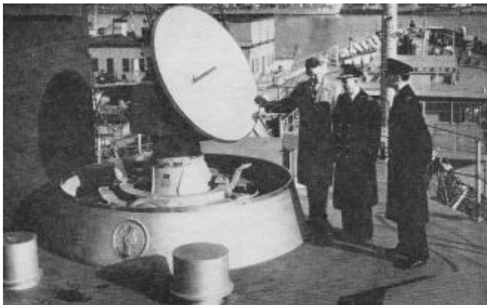
Slika 19. Antenski sustav radio sekstanta AN/SRN-4 instaliran na USS "Compass Island".
