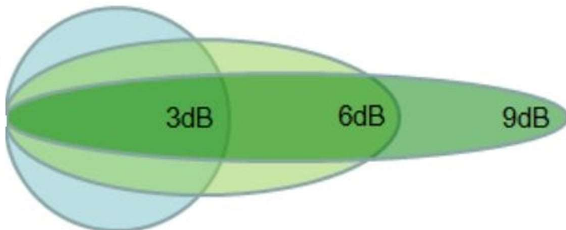
Slika 7: Prikaz dvostrukog, četverostrukog i osmostrukog dobitka antene
