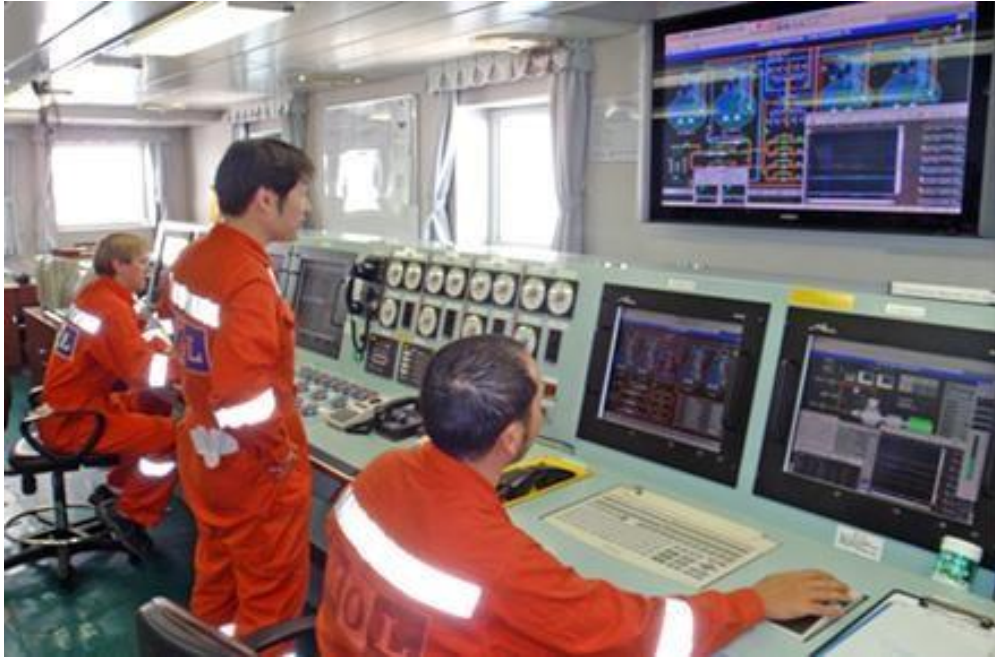
Slika 7: Posada u kontrolnoj sobi tereta prati proces ukrcanja/iskrcanja LNG-a
