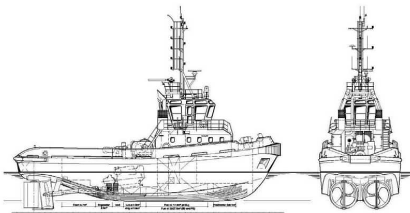
Slika 19. Shematski prikaz konvencionalnog tegljača s dva vijka u sapnicama
