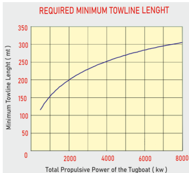
Slika 28. Grafikon 2. Minimalna duljina ispusta teglenog konopa u odnosu na ukupnu snagu poriva tegljača (kw)
