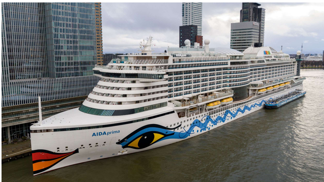
Slika 4. Prikaz opskrbe putničkog broda AIDAprima sa 140mt B100 biodizela u luci Rotterdam
