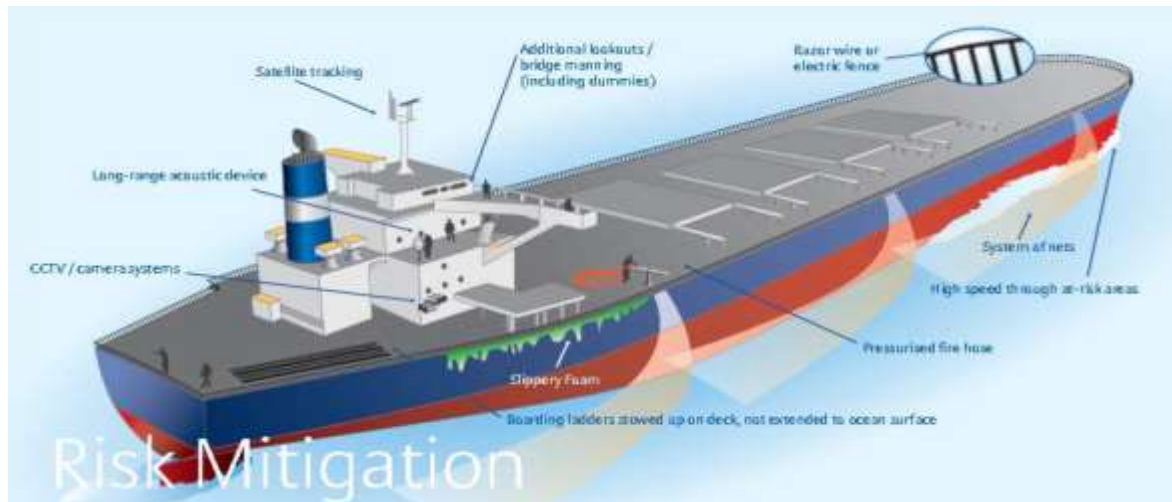
Slika 12. BMP vrste fizičkih mjera zaštite protiv pirata
