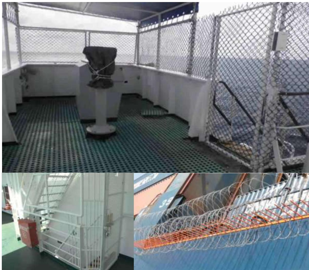
**Slika 11. Fizičke prepreke u zaštiti pojedinih dijelova broda**
