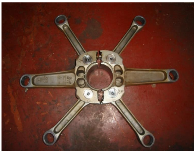
Slika 3.1 Sklop-klipnjača brzookretnog radijalnog dizelskog motora
