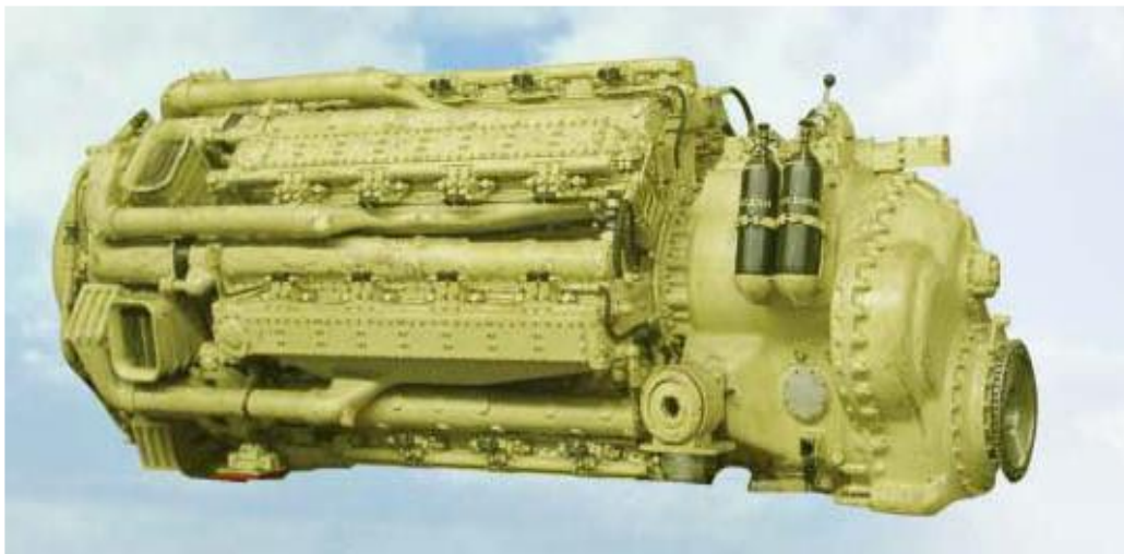
Slika 3.2 Brzookretni radijalni brodski dizelski motor M 504 B2
