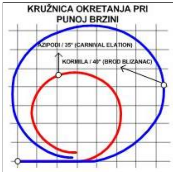
Slika 2. Usporedba kružnica okretanja dva broda blizanaca pri punoj brzini (broda s dva vijka i dva lista kormila i broda s usmjerenom propulzijom)
