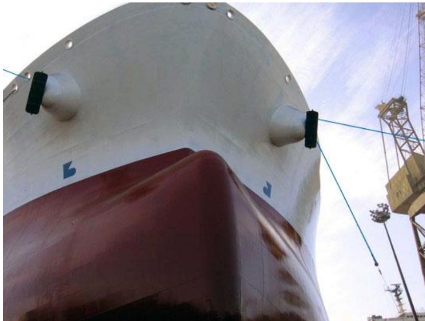
Slika 4. 440 000 DWT supertanker nakon nanošenja FP zaštitnog premaza
