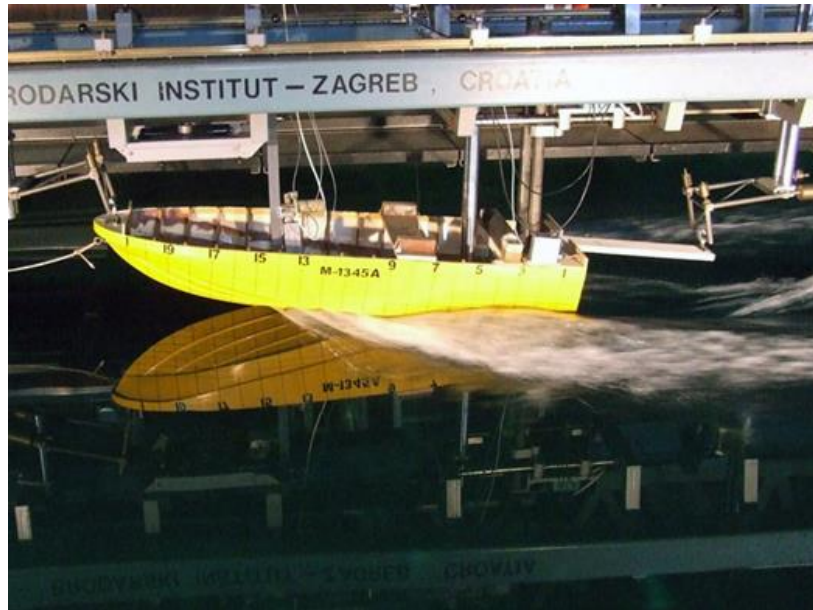
Slika 6. Modelsko ispitivanje broda u bazenu
