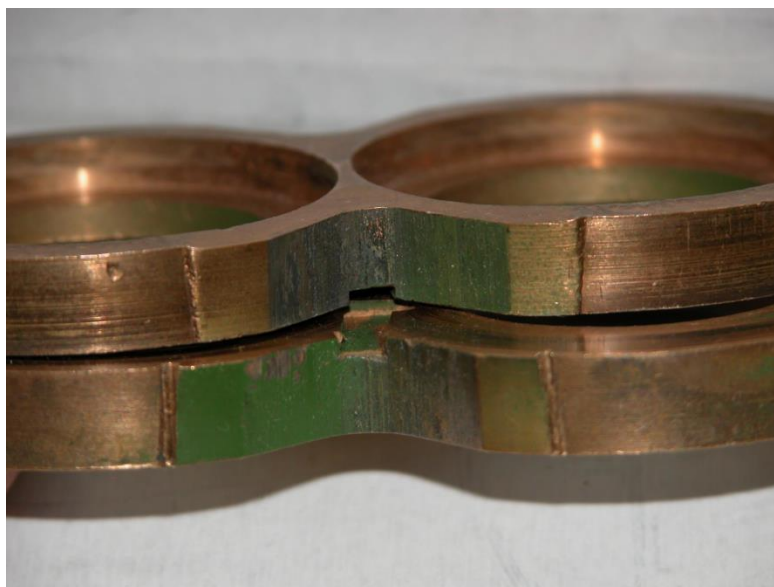
Slika 5.15. - Pumpa zategnuta van specifikacija koje izdaje proizvođač
