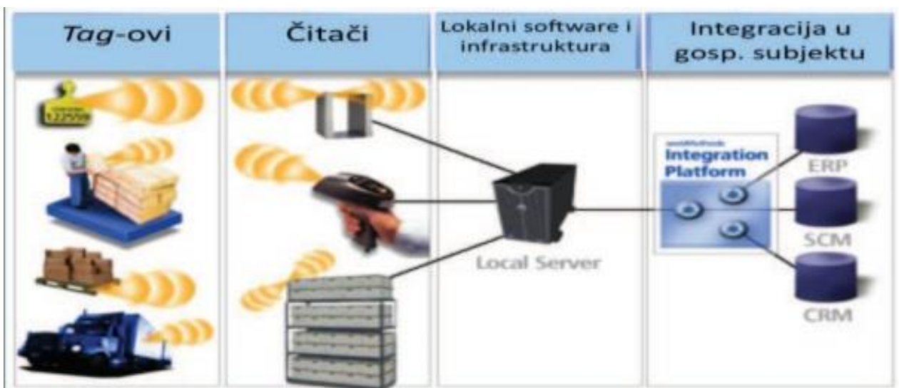
Slika 6. RFID principi djelovanja
