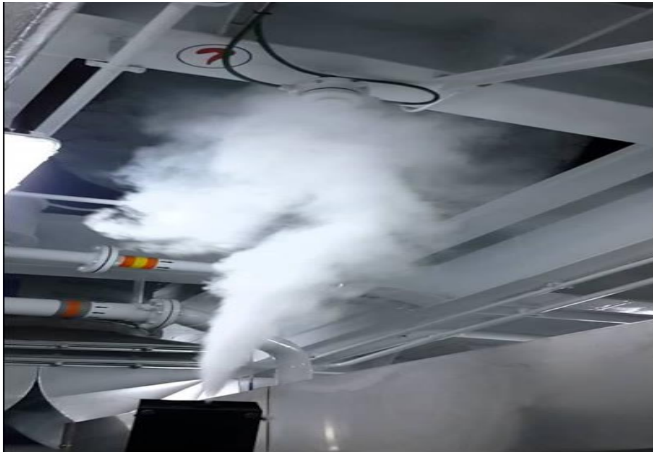
Slika 3: Testiranje senzora za dim
