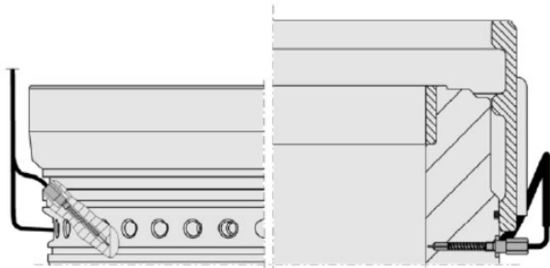
**Slika 5.** Mjerenje temperature košuljice cilindra s termoparom [3]
