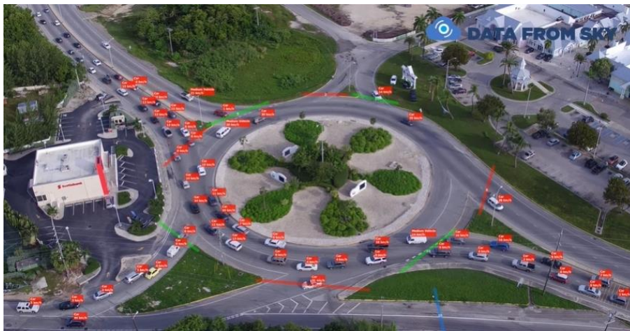
Slika 14 Brojanje vozila i njegove brzine na kružnom toku pomoću drona
