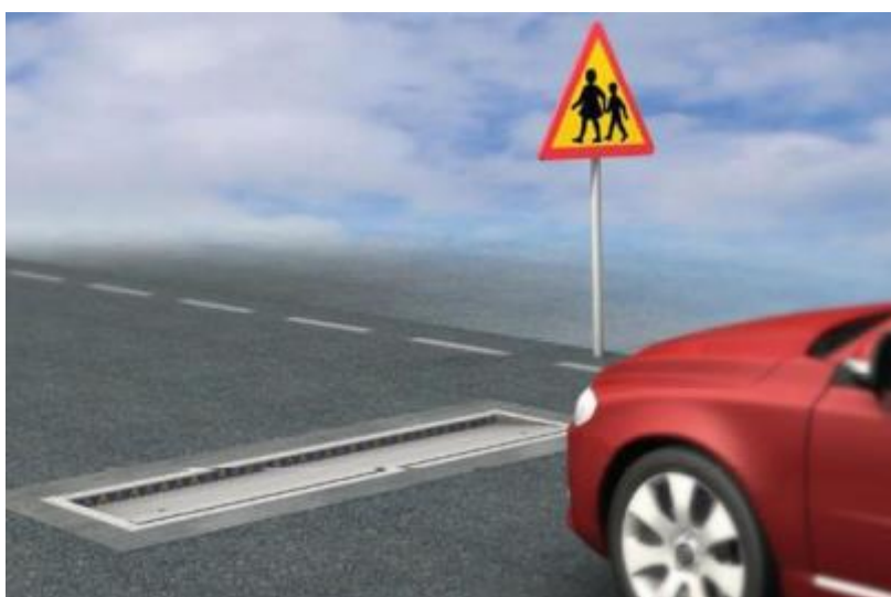
Slika 16 Podesivi cestovni uspornik
