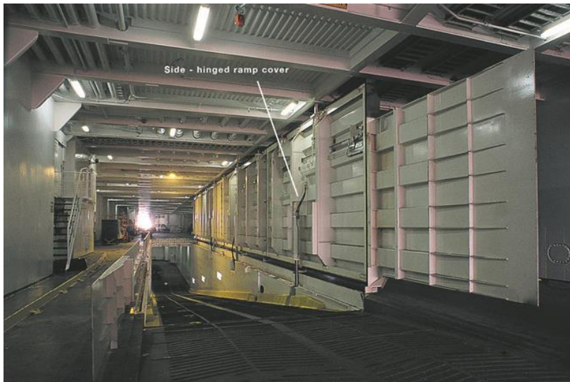
Slika 8 Unutarnja rampa RO-RO broda, sa označenim bočnim otvorom
