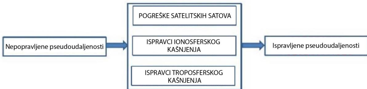
*Slika 11. Model popravka izvornih (nepopravljenih) izmjerениh GNSS pseudoudaljenosti u navigacijskoj domeni GNSS prijamnika za satelitsku navigaciju*
